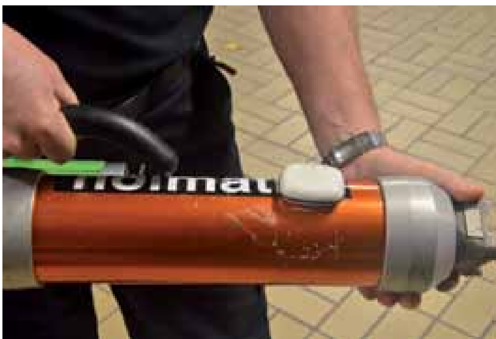
Ett 80-tal sensorer har satts fast på verktygen på släckbilen på station Jägersro i Malmö. Magnetsensorerna skickar information om användningen till Linköpings universitet och forskaren Magnus Bång.
