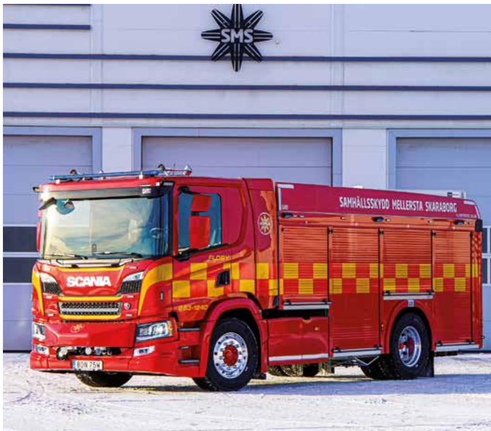
Den nya släck- och tankbilen i Floby är ny i sitt slag. Fordonet har enkelhytt vilket ger utrymme för bland annat mer vatten - 6 500 liter närmare bestämt.
