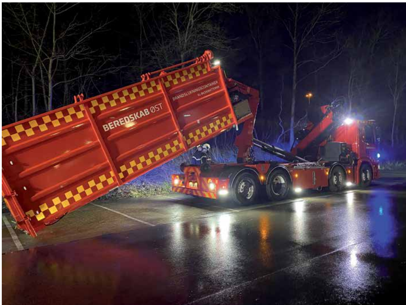
Containern transporteras med lastväxlare från brandstationen i Gentofte. Elbilen kan antingen vinschas in i containern, eller lyftas in ovanifrån med hjälp av lastbilens kran.
