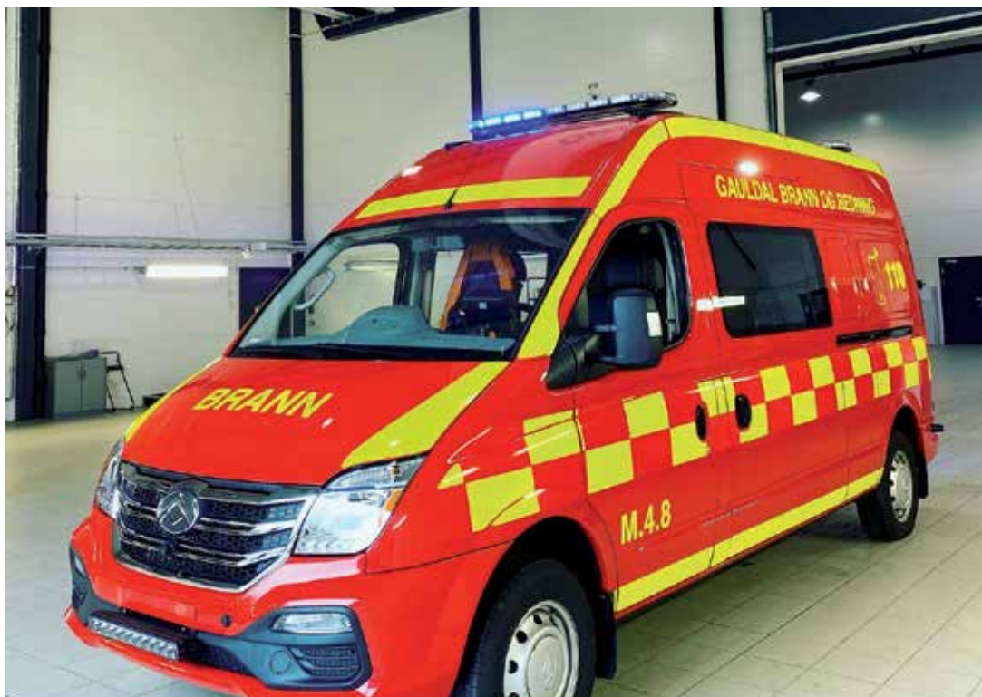
Den anpassade skåpbilen kan evakuera tolv personer i taget ur norska Sokedalstunneln.
