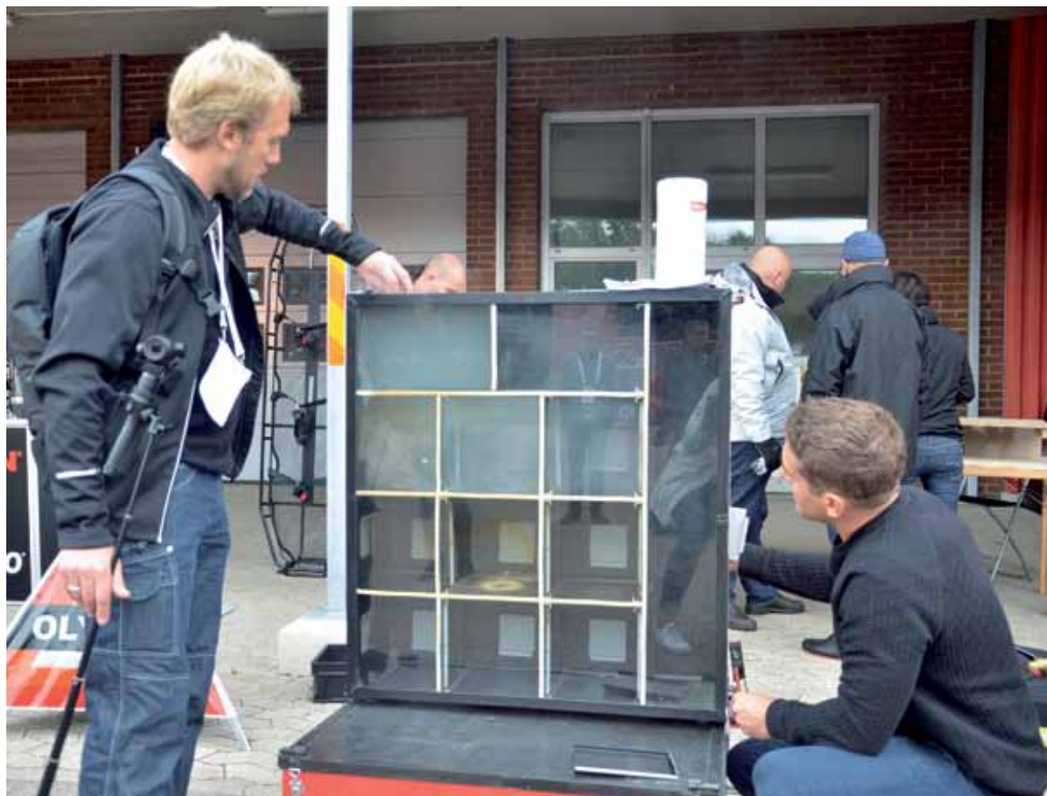
Erik Elvermarks (t.v.) uppfinning visar hur varma rökgaser sprider sig. Det lilla huset har köpts in av Uppsala brandförsvär och förevisades av Fredrik Sedvall (t.h.).
