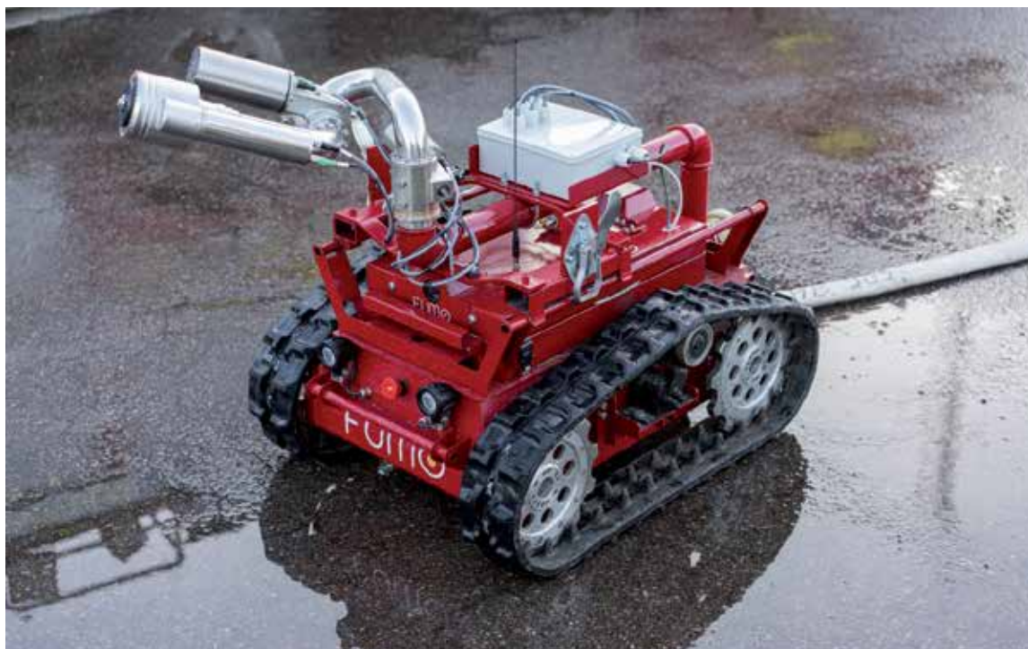
Brandroboten Fumo med släcklavett och grovslang.
